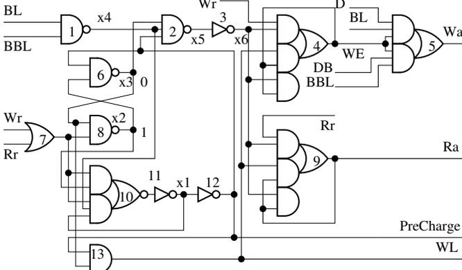
FIGURE 7 SI CONTROLLER FOR 6T SRAM CELL.
